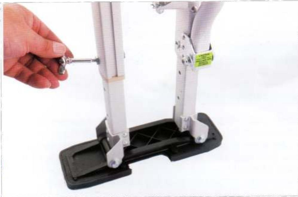
**Parafusos para ajuste de altura**
