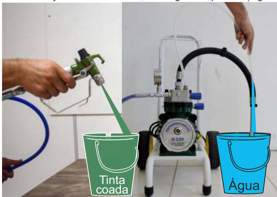
7. Espere a tinta sair e assim que chegar a água desligue a máquina.
