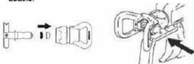
4. Após montado o Bico e a Vedação no Porta bico parafuse o conjunto na pistola de pintura.
